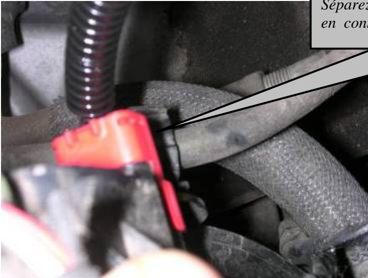
Image 2 : Détail de la connexion électrique.
